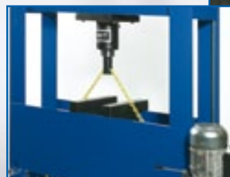
Puristinpöydän nosto ja lasku tehdään sylinterillä vakiovarusteena olevaa ketjua apuna käyttäen.
