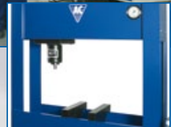
Sivuttaissuunnassa siirrettävä puristussylinteri ja alasinpari vakiovarusteena.
